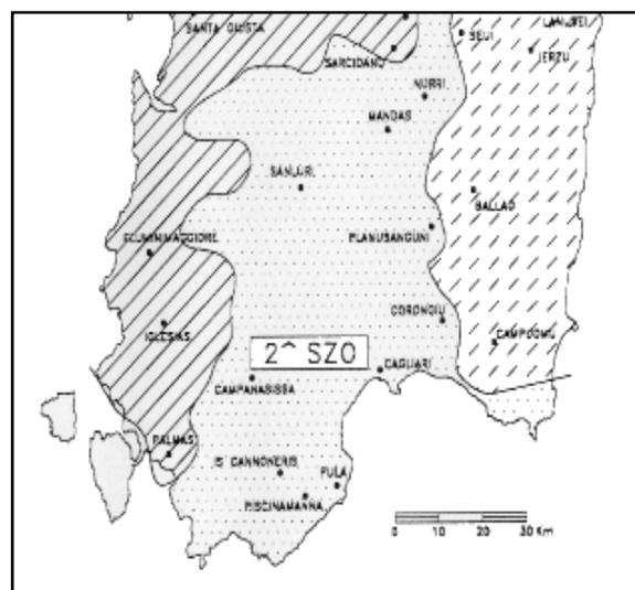
Figura 9 – Sotto Zone Omogenee per le piogge brevi e intense in Sardegna. In ciascuna zona i parametri del modello TCEV sono riportati in Tabella 8. (da Deidda ed. al., 1993)
